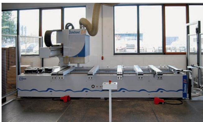
Auf die Plattenverarbeitung spezialisiert: Neben diesem BAZ gibt es noch eine Plattensäge, eine Kantenanleim- und eine Breitbandschleifmaschine
